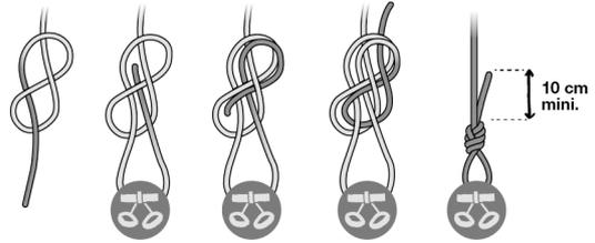
**6c. Connecting a belay system / Connexion d'un système d'assurance**
